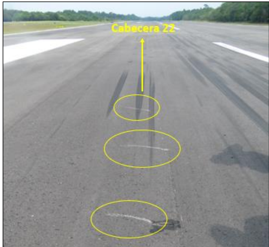
Fotografía No. 2: Marcas de impacto de hélice contra el pavimento HK1010G SKEJ
