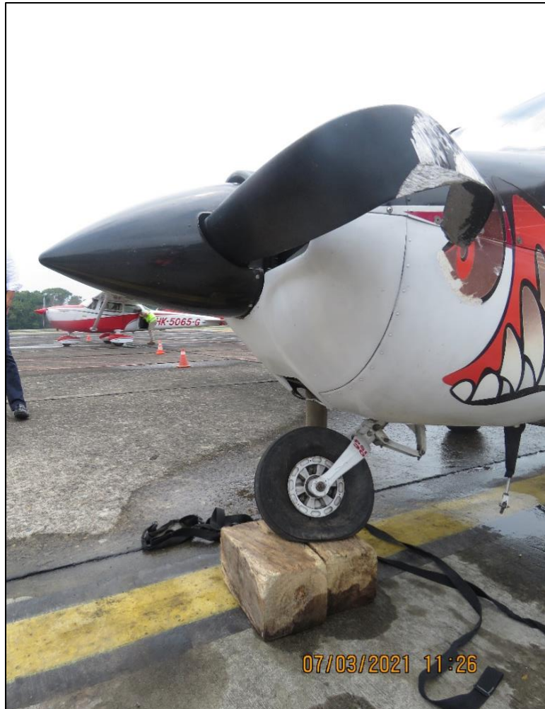
Fotografía No. 4: Estado final hélice y tren de aterrizaje de nariz aeronave HK1010G
