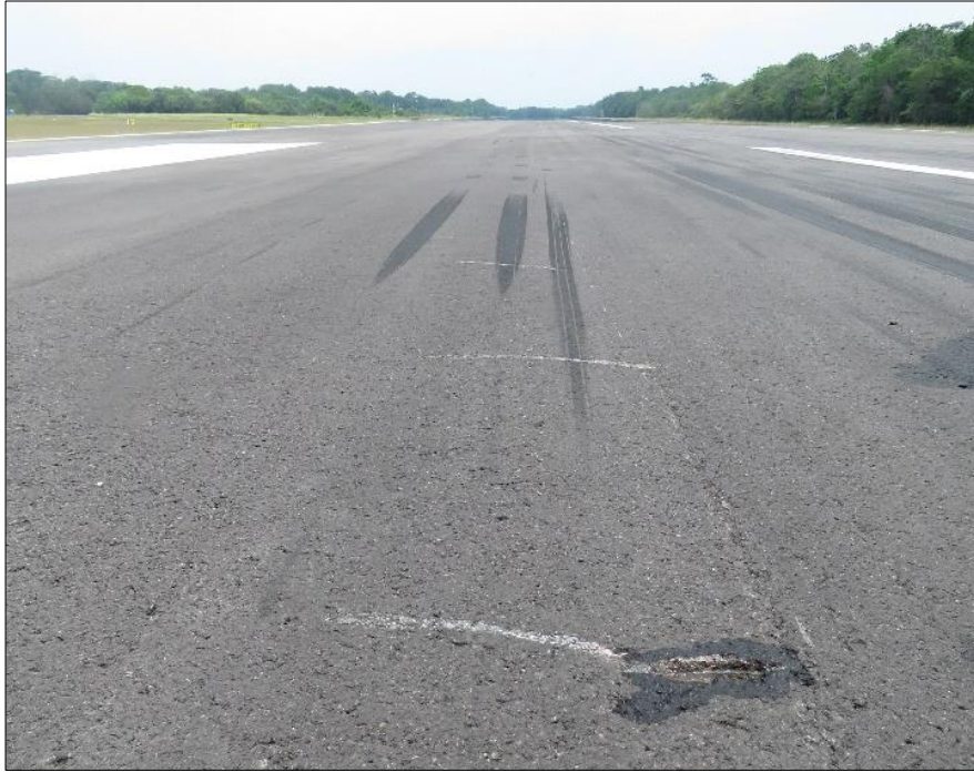
Fotografía No. 1: Marcas de impacto de hélice contra el pavimento HK1010G SKEJ
